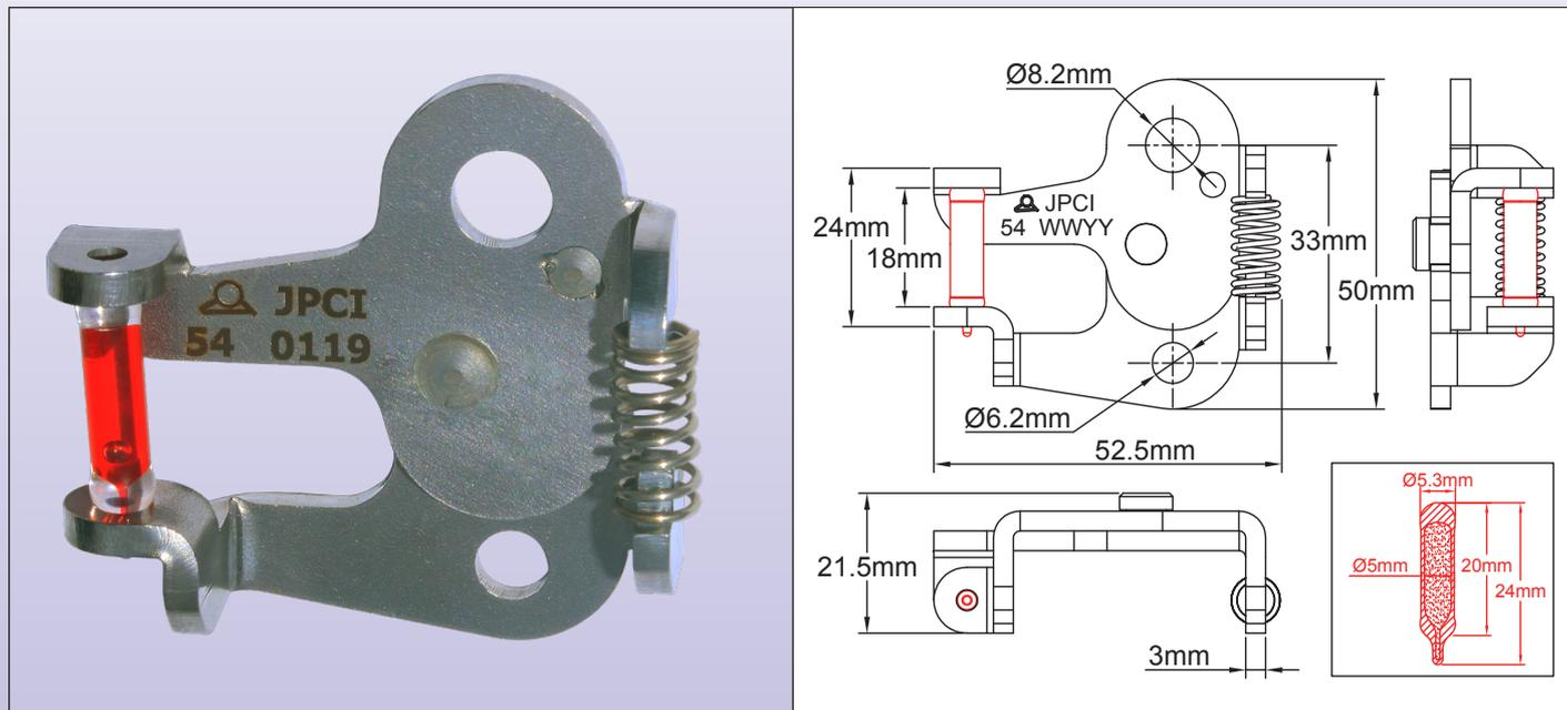
Hechos de acero galvanizado de 3 mm de grosor, estos mecanismos de reducción son compatibles con bulbos de vidrio térmico de 20 × 5 mm. Su enorme coeficiente de multiplicación reduce la fuerza aplicada al bulbo de vidrio térmico a solo el 15 % de la aplicada al mecanismo. El reemplazo del bulbo de vidrio es sencillo y se puede realizar sin herramientas especiales. Resisten la sobrecarga de 300 DaN durante 5 minutos y una carga mínima de 0,4 DaN.
